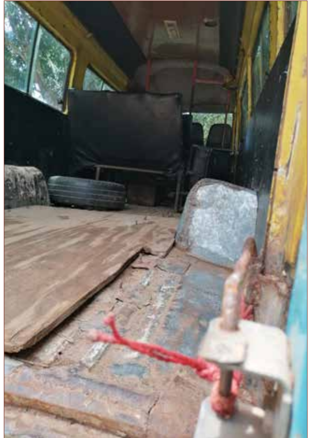
Der Bus ist dabei zu verrotten
